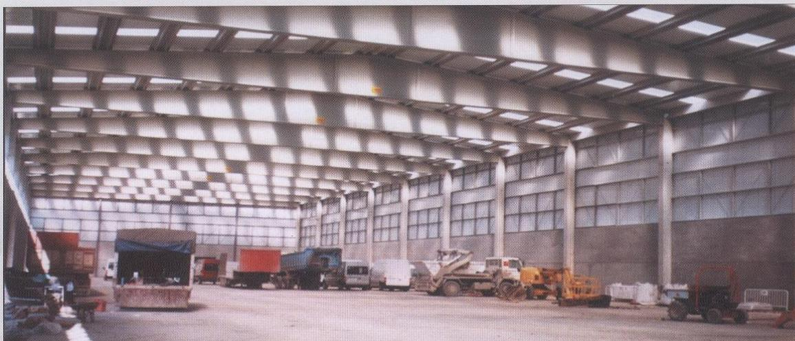
Grandes luces y alturas solucionadas con vigas R.N.I., correas TT y panel de cerramiento.
